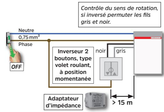
Avant la mise en service, possibilité d'utiliser un inverseur à position fixe avec inter-verrouillage. La validation automatique du moteur selon le type d'inverseur est verrouillée après 3 allers-retours sans interruption.
